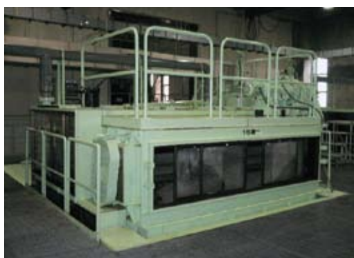
写真3 ベルトプレス脱水機外形
